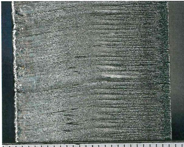
Abbildung 2 Schnittqualität der Probe am geraden Schnitt
