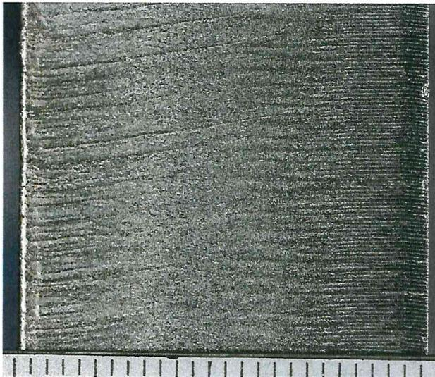
Abbildung 2 Schnittqualität der Probe am geraden Schnitt
